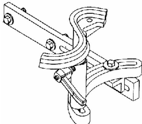
Рис. 14 - Упор для обработки заготовки большого диаметра
